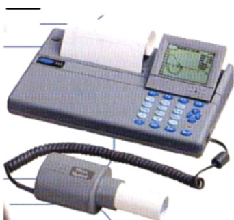
Figure 4. Système spirométrique comprenant écran PC, logiciel avancé de spirométrie, capteur avec turbine et adaptateur pour embout spécifique.
