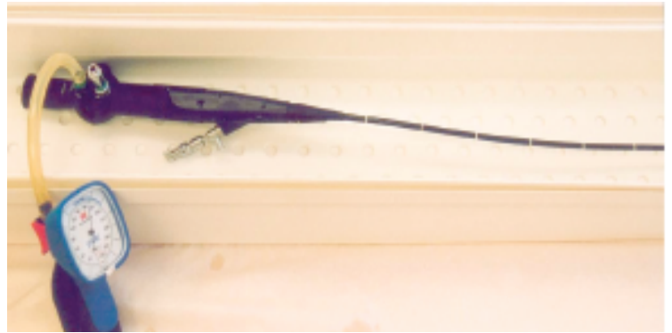
Test d'étanchéité d'un fibroscope
