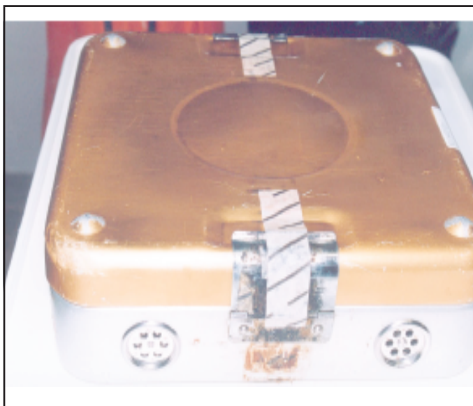
Témoins extérieurs et cadenas permettant de contrôler le passage à l'autoclave (mais pas la stérilité du matériel)
